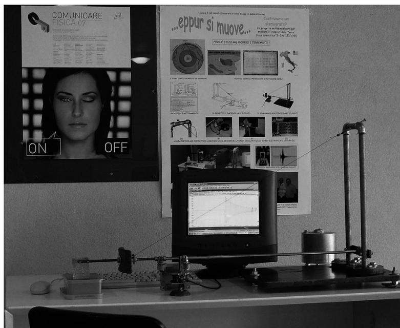
Figura 2: il sismografo in allestimento dimostrativo
