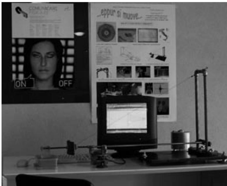
Figura 2: il sismografo in allestimento dimostrativo
